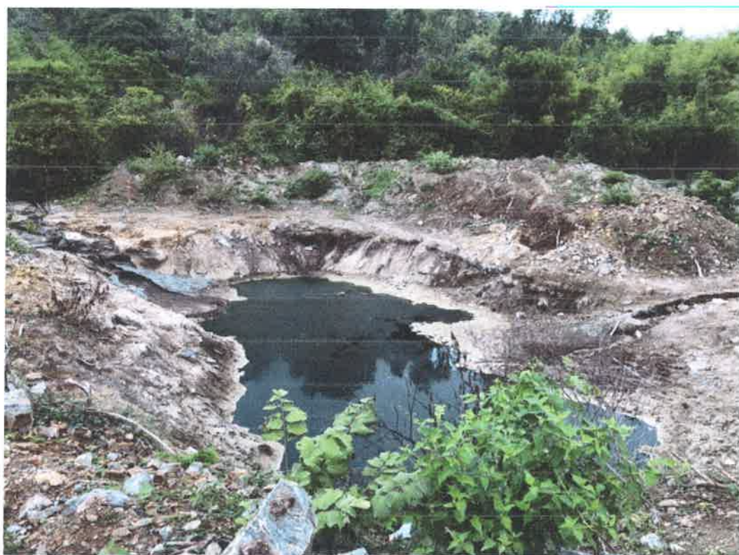
ภาพที่ ๕: ปอดักตะกอนบริเวณที่ต่ำของหน้าเหมือง เพื่อพักน้ำก่อนระบายออกนอกพื้นที่ประทานบัตร
