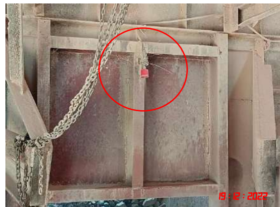
ระบบสเปรย์น้ำบริเวณจุดกำเนิดฝุ่นละออง
