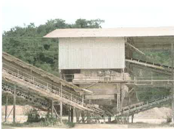
รูปที่ 15 การปิดคลุมอาคารโรงไม้หิน ชุด Product Screen
