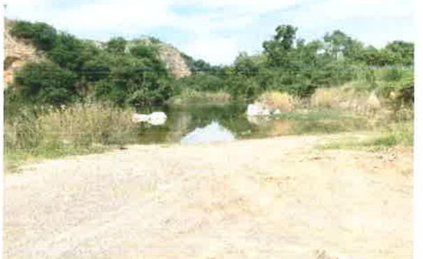
รูปที่ 6 Sump ที่ 1 รองรับน้ำขุ่นข้นและตะกอนดินที่เกิดจากการชะล้างบริเวณหน้าเหมือง
