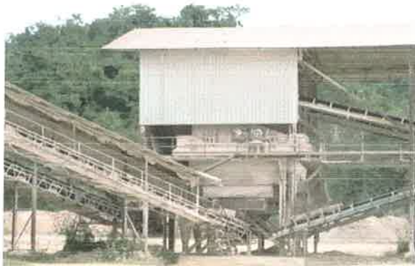
รูปที่ 15 การปิดคลุมอาคารโรงไม้หิน ชุด Product Screen
