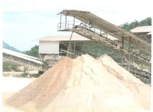
รูปที่ 6 เปลือกดินจากหน้าเหมื่อนนำมาผสมเป็นผลิตภัณฑ์หินคลุกเพื่อจำหน่าย
