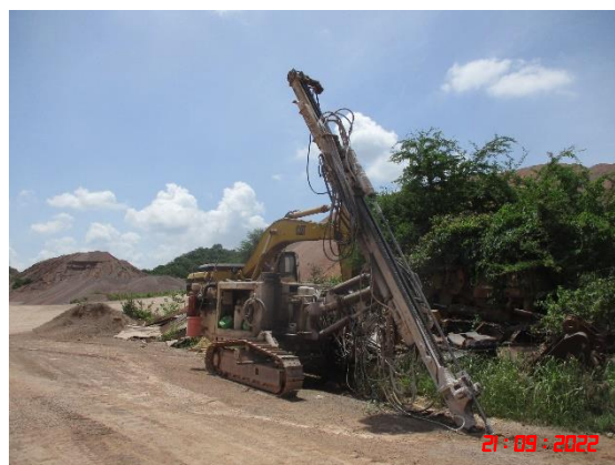
รูปที่ 16 เครื่องเจาะรื้อระเบิดที่มีอุปกรณ์เก็บฝุ่นติดไว้กับหัวเจาะ
