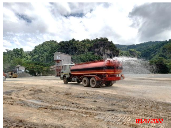
รูปที่ 11 การฉีดพรมน้ำตามเส้นทางขนส่งแร่
