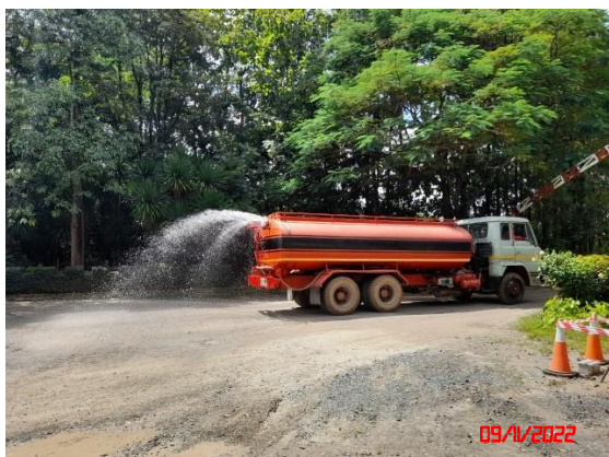
รูปที่ 11 การฉีดพรมน้ำตามเส้นทางขนส่งแร่
