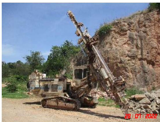
รูปที่ 19 เครื่องเจาะระเบิดที่มีอุปกรณ์เก็บฝุ่นติดไว้กับหัวเจาะ
