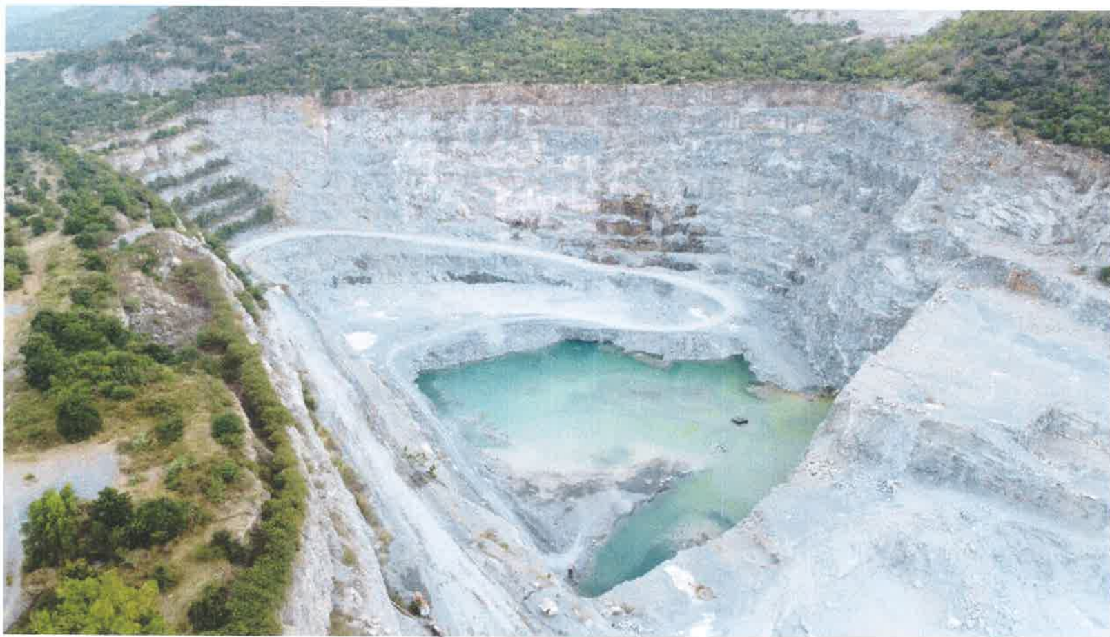
ภาพ ที่ 10 : บ่อพักน้ำคัดตะกอนบริเวณที่พื้นที่ต่ำสุดของหน้าเหมืองภายในพื้นที่โครงการ
