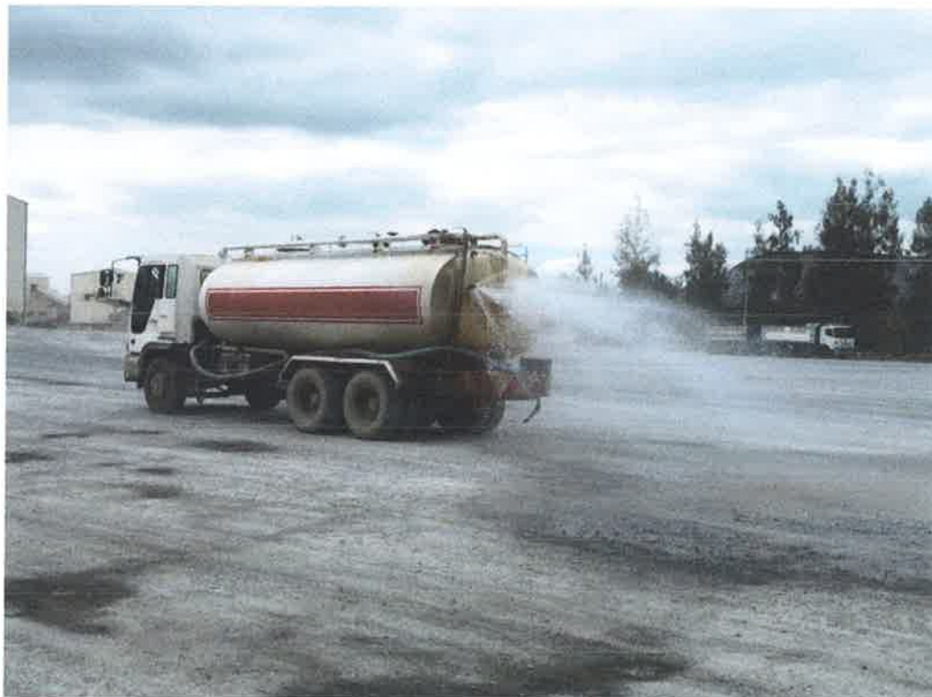
ภาพที่ ๑ : การนำน้ำจากบ่อกักน้ำดีตะกอนมาใช้ลาดถนนและพื้นที่ต่างๆที่เกิดฝุ่นฟุ้งกระจาย
