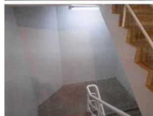
ภาพบันไดหนีไฟและเส้นทางหนีไฟ มีระบบแสงสว่าง ไม่มีสิ่งกีดขวาง ผนังหรือประตูทำด้วยวัสดุทนไฟ สามารถใช้หนีไฟในกรณีฉุกเฉินได้
