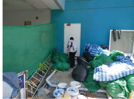
ตรวจสอบและวางแผนแก้ไขพื้นที่บริเวณทางออกฉุกเฉินโดยนำไฟและเส้นทางหนีไฟให้ไม่มีสิ่งกีดขวาง เนื่องจากอาจเป็นอุปสรรคต่อการอพยพเมื่อเกิดเหตุฉุกเฉิน
