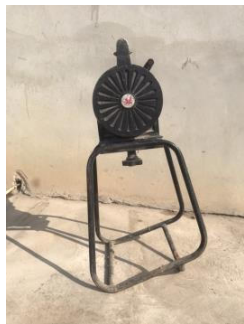
รูปที่ 2-9: หวอสัญญาณเตือนการระเบิด
