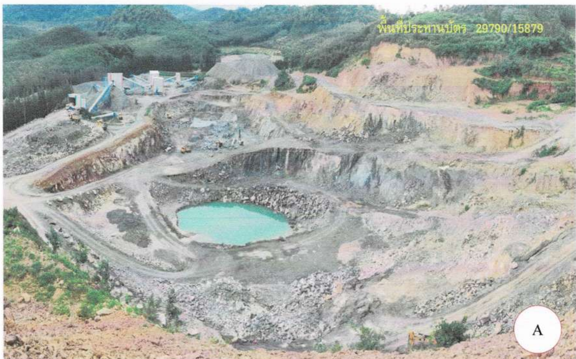
ภาพที่ 2 แสดงการพัฒนาและฟื้นฟูเหมืองแบบชันบันไดแบบปลอดภัย
