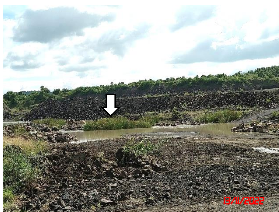
รูปที่ 15 บ่อรับน้ำ (Sump) บริเวณหน้าเหมือง
