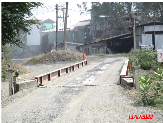
รูปที่ 16 จุดชั่งน้ำหนักบรรทุกทุกและจุดล้างล้อ
