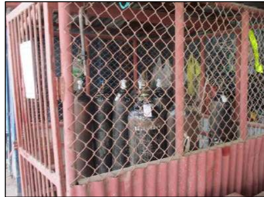
รูปที่ 2-10 จัดเก็บถังแก๊สอย่างเป็นระเบียบเรียบร้อย
