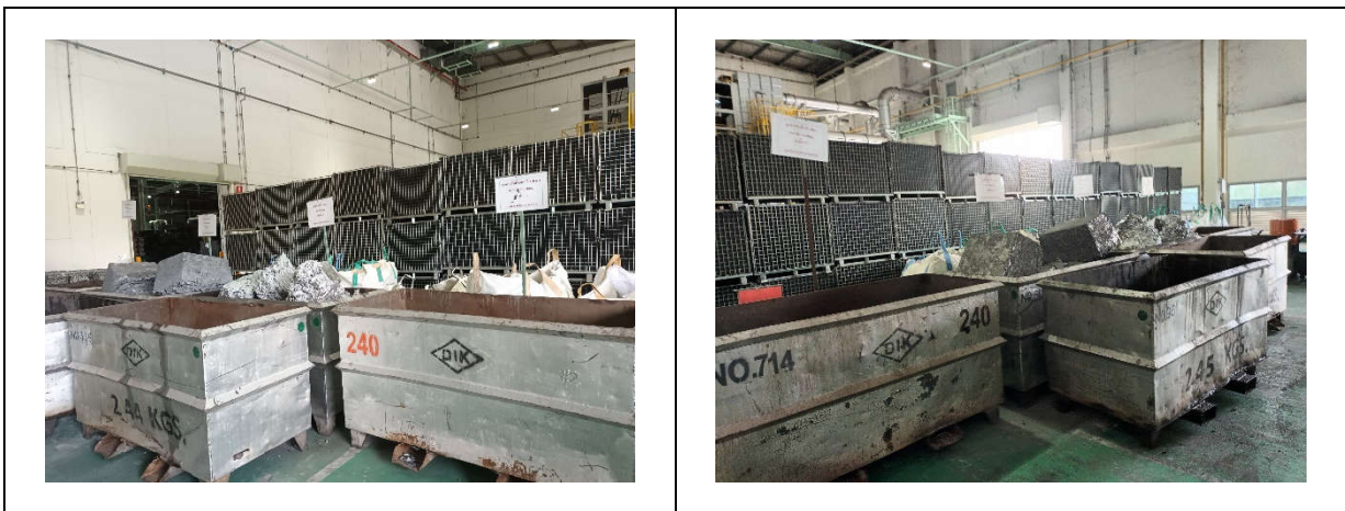
รูปถ่ายที่ 3.2-31 : ถังเหล็กขนาดใหญ่สำหรับเก็บรวบรวม Dross
