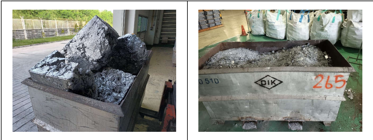
รูปถ่ายที่ 3.2-30 : ตะกรันอะลูมิเนียม (Aluminium Dross)
