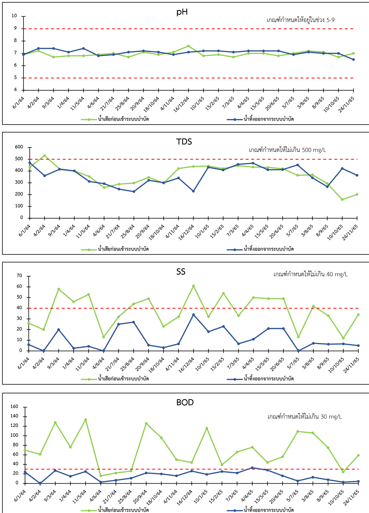
ภาพที่ 3.5-2 กราฟเปรียบเทียบผลการวิเคราะห์คุณภาพน้ำจากระบบบำบัดน้ำเสียของโครงการ
