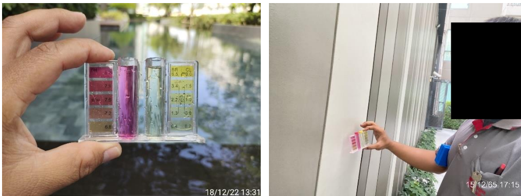
ภาพที่ 3.5.5-2 การตรวจวัด pH, Cl 2 สระว่ายน้ำ
