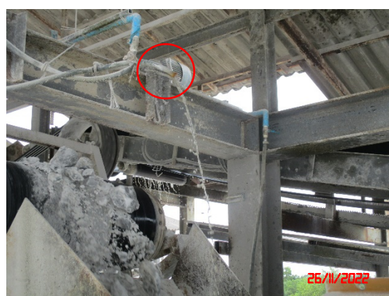
ระบบสเปรย์น้ำบริเวณตะแกรงคัดขนาด
