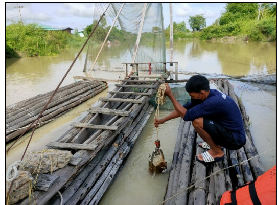
ภาพที่ 2.5.6-12 การเก็บสัตว์น้ำดินด้วยเครื่องมือแกร็บ
