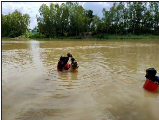
ภาพที่ 2.5.6-12 การเก็บสัตว์น้ำดินด้วยเครื่องมือแกร็บ
