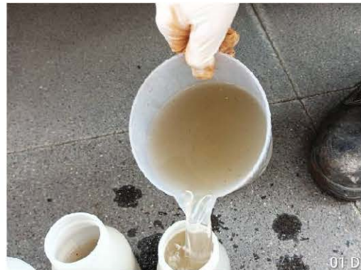
การเก็บตัวอย่างคุณภาพน้ำทิ้งก่อนการบำบัด บริเวณบ่อปรับสภาพน้ำ
