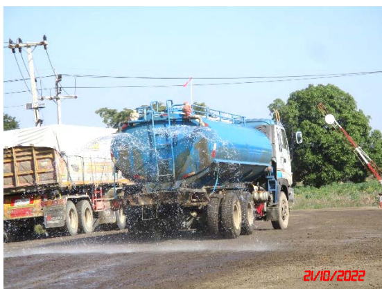
รูปที่ 12 การฉีดพรมน้ำบริเวณเส้นทางขนส่งแร่
