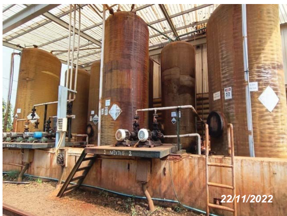
ถังเก็บและระบบท่อนำส่งกรดเกลือในกระบวนการผลิต
