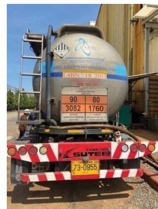
รถขนส่งสารเคมีที่มีเครื่องหมาย ฉลากและป้ายบนรถขนส่ง
