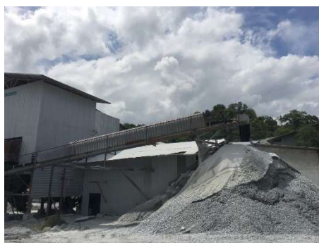
รูปที่ 2-11: การปิดคลุมสายพานลำเลียง
