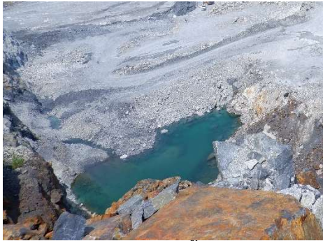
รูปที่ 2-14: บ่อรับน้ำ (Sump)
