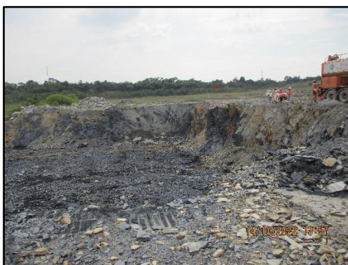
ภาพที่ 2.12 การเปิดหน้าเหมืองด้วยวิธีเหมืองหาบในลักษณะ Open Pit
