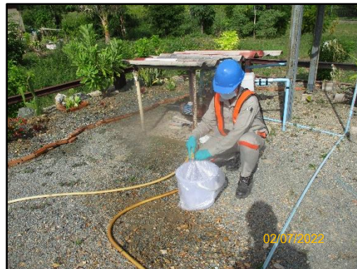
ภาพที่ 3.33 การตรวจวัดคุณภาพน้ำใต้ดิน บริเวณน้ำบ่อต้นบ้านช่องใต้
