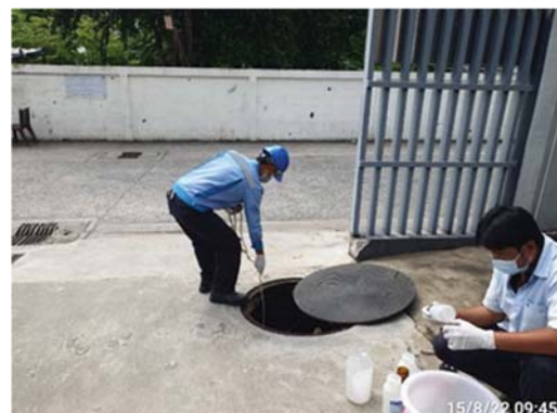
ภาพที่ 3.5.3-1 การเก็บตัวอย่างน้ำทิ้ง
