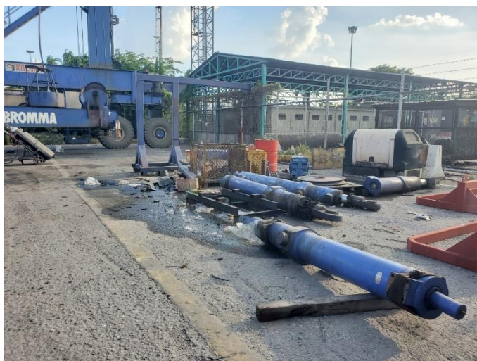
ภาพที่ 2 ขณะนั้นพนักงานช่างสังเกตเห็นคราบน้ำมันไฮดรอลิกค่อยๆไหลออกจากกระบอกระบาย TLS ที่วางอยู่ที่พื้น พนักงานจึงรีบวิทยุแจ้งหัวหน้างานทันที น้ำมันไฮดรอลิกไหลออกมา 1 นาที จึงหยุดไหล ปริมาณน้ำมันที่รั่วไหลทั้งหมดเท่ากับ 60 ลิตร (30 ลิตร/30 วินาที)
