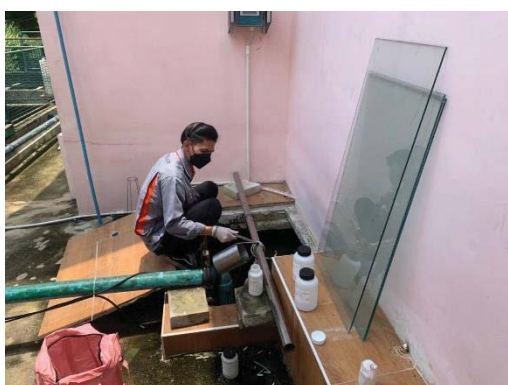
ภาพที่ 3.5.4-1 แสดงวิธีการเก็บตัวอย่างคุณภาพน้ำทิ้ง
