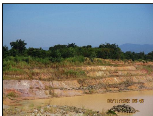
ภาพที่ 2.11 การทำเหมืองแบบชันบันได
