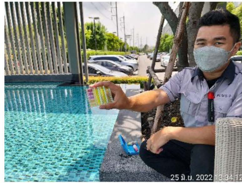
ภาพที่ 3-2 เจ้าหน้าที่ตรวจวัดค่า pH และ Chlorine
