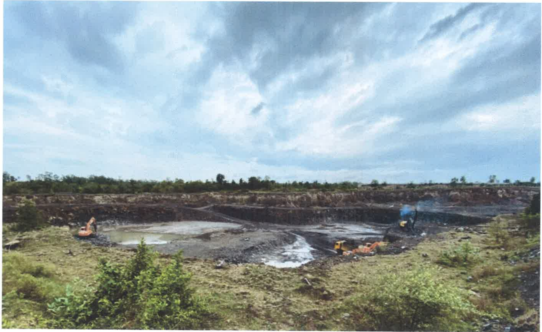
( รูปที่ 1 ) หน้าเหมืองแบบขั้นบันได
