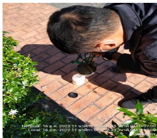
3.5.2-1 การเก็บตัวอย่างน้ำบ่อบำบัดน้ำทิ้งสุดท้ายก่อนปล่อยลงท่อระบายน้ำสาธารณะ
