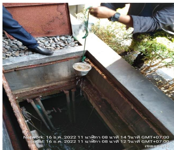
3.5.2-1 การเก็บตัวอย่างน้ำบ่อบำบัดน้ำทิ้งสุดท้ายก่อนปล่อยลงท่อระบายน้ำสาธารณะ
