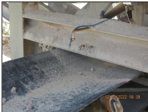
ภาพที่ 2.15 การติดตั้งระบบสปริงน้ำบริเวณจุดกำเนิดฝุ่น
