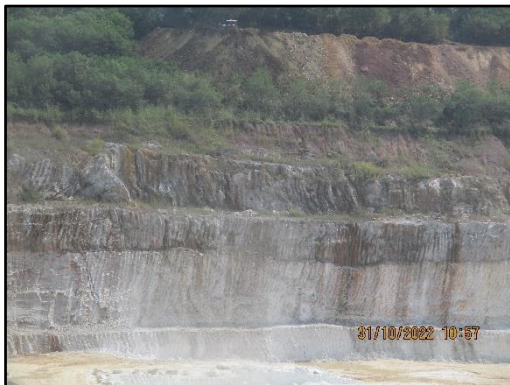
ภาพที่ 2.4 การเปิดหน้าเหมืองในแบบลักษณะชั้นบันได
