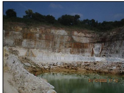
ภาพที่ 2.4 การเปิดหน้าเหมืองในแบบลักษณะชั้นบันได
