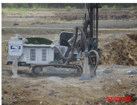
รูปที่ 4 เครื่องเจาะระเบิดที่มีอุปกรณ์เก็บฝุ่นติดไว้ที่หัวเจาะ
