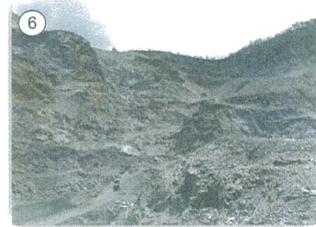
หน้าเหมืองมีลักษณะเป็นชั้นบันได (Bench) มีความสูงหน้าเหมืองไม่เกิน 10 เมตร ความลาดชันรวมไม่เกิน 45 องศา
