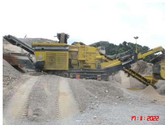
รูปที่ 22 เครื่องจักรอุปกรณ์ในการบด ย่อยหินแบบเคลื่อนที่ (Mobile Machine)
