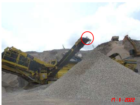
รูปที่ 23 ระบบสายพานลำเลียงบริเวณเครื่องจักรอุปกรณ์ในการบด ย่อยหินแบบเคลื่อนที่ได้
