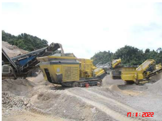
รูปที่ 22 เครื่องจักรอุปกรณ์ในการบด ย่อยหินแบบเคลื่อนที่ (Mobile Machine)
