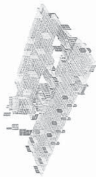
รูปที่ 4: การจำลองที่แสดงการเชื่อมต่อเป็น Plate Elements
