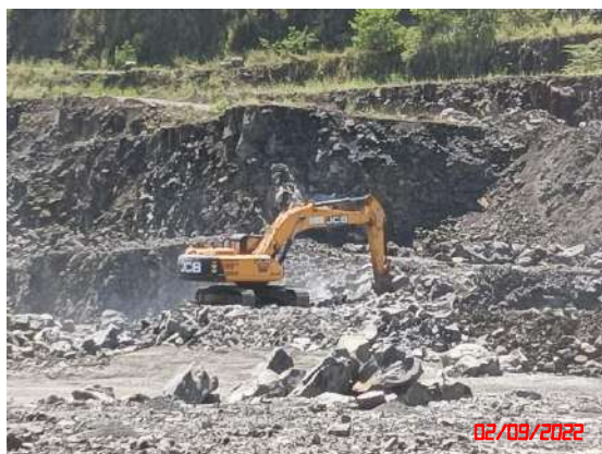
รูปที่ 8 การตัด/เจาะกระแทกย่อยแร่ให้มีขนาดเล็กลง
