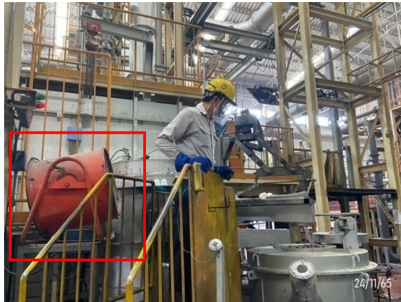
รูปที่ 3-34 พัฒนาระบายอากาศบริเวณพื้นที่เตาหลอม
