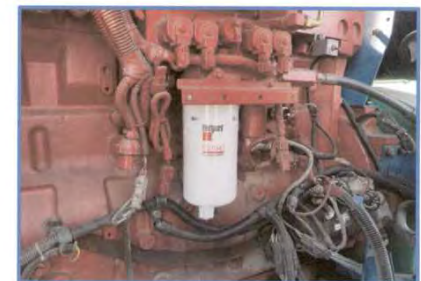
RTG 001 วันที่ 17 พฤศจิกายน 2565 ตรวจสภาพ 250 ชั่วโมง ครั้งที่ 2 เปลี่ยนถ่ายน้ำมันเครื่อง หลังทำ
