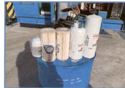
RTG 001 วันที่ 17 พฤศจิกายน 2565 ตรวจสภาพ 250 ชั่วโมง ครั้งที่ 2 เปลี่ยนถ่ายน้ำมันเครื่อง หลังทำ
