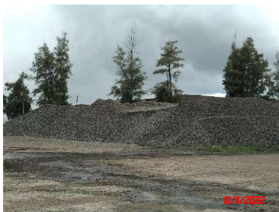
รูปที่ 7 ลานเก็บกองแร่ที่เป็นลานหินบดอัดแน่น
