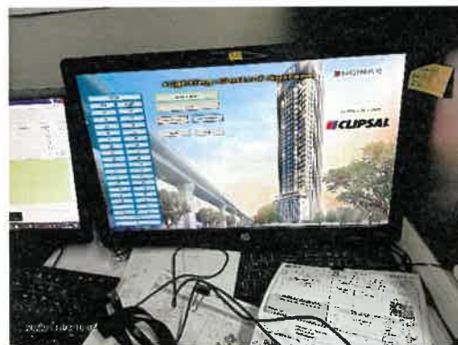
ระบบควบคุมการเปิดปิดไฟในพื้นที่ส่วนกลาง
