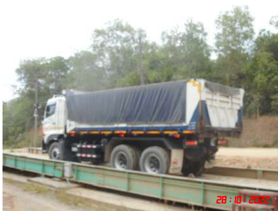
รูปที่ 21 การปิดคลุมกระบะรถบรรทุก
