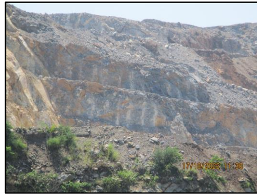
ภาพที่ 2.2 การทำเหมืองแบบขั้นบันได
