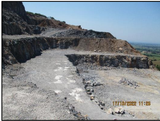
ภาพที่ 2.2 การทำเหมืองแบบขั้นบันได
