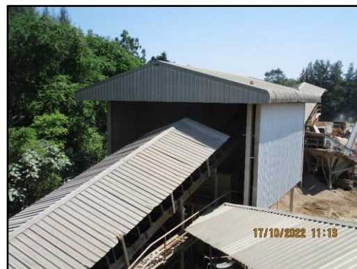
ภาพที่ 2.8 การปิดคลุมเครื่องจักรเป็นระบบปิด
