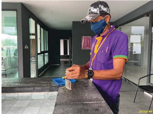
ภาพที่ 3.5.4-2 การตรวจวัดค่าความเป็นกรด-ด่าง และคลอรีน
