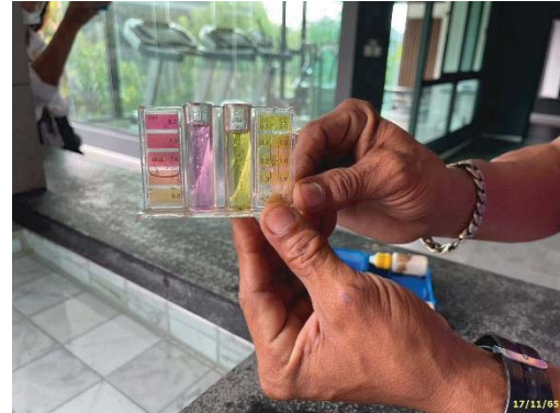
ภาพที่ 3.5.4-2 การตรวจวัดค่าความเป็นกรด-ด่าง และคลอรีน
