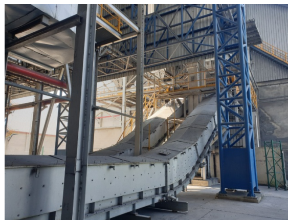
รูปที่ 2-28 ระบบลำเลียงเถ้าจากห้องเผาไหม้หม้อไอน้ำมีการปิดครอบมิดชิด
