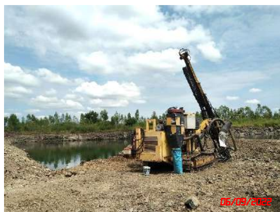
รูปที่ 18 เครื่องเจาะระเบิดที่มีอุปกรณ์เก็บฝุ่นติดไว้กับหัวเจาะ
