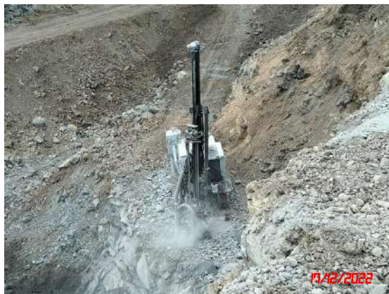
รูปที่ 16 การฉีดพรมน้ำเพื่อลดการฟุ้งกระจายของฝุ่นละออง
