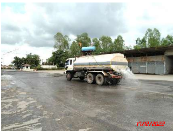
รูปที่ 16 การฉีดพรมน้ำเพื่อลดการฟุ้งกระจายของฝุ่นละออง
