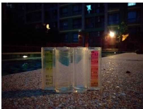
ภาพที่ 3.5.4-1 การตรวจวัด pH Test Kit และ Chlorine Test Kit
