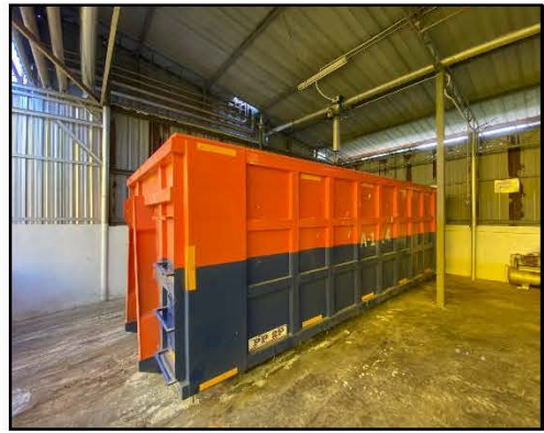
ภาพที่ 3.2 ภาชนะเก็บพักกากข้าวเจ้า กากมอลต์ และกากยีสต์ที่มีการปิดมิดชิด
