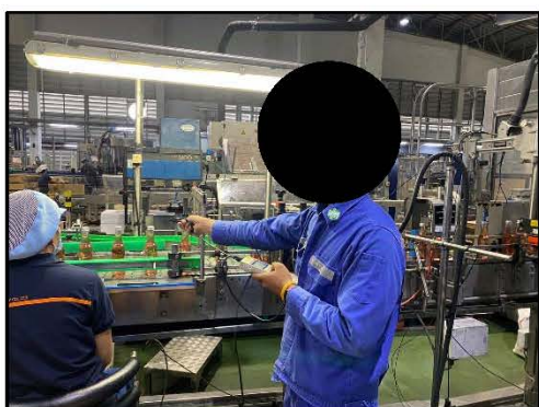
รูปที่ 4.2.13-1 ภาพถ่ายภาพการตรวจวัดแสงสว่างในการทำงาน
