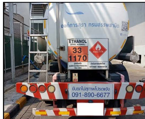
ภาพที่ 3.27 รถขนส่งของเสียอันตรายที่มีระบบติดตาม ตรวจสอบการขนส่งด้วยระบบ GPS และมีการติดเบอร์โทรศัพท์
