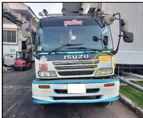
ภาพที่ 3.27 รถขนส่งของเสียอันตรายที่มีระบบติดตาม ตรวจสอบการขนส่งด้วยระบบ GPS และมีการติดเบอร์โทรศัพท์
