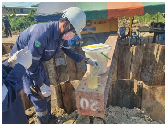
การเก็บตัวอย่างน้ำจากการทดสอบ เมื่อดำเนินการทดสอบท่อแล้วเสร็จ
