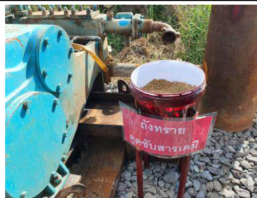
ภาพที่ 3-17 : ถาดเก็บรองรับน้ำมันและวัสดุดูดซับสารเคมี
