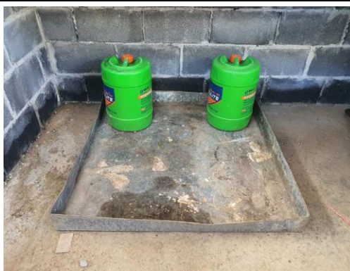
ภาพที่ 3-17 : ถาดเก็บรองรับน้ำมันและวัสดุดูดซับสารเคมี
