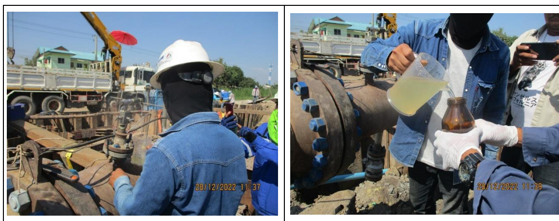
ภาพที่ 4.3-1 : การเก็บตัวอย่างน้ำทั้งจากการทดสอบด้วยวิธีทางชลสถิต (Hydrostatic Test) วันที่ 28 ธันวาคม พ.ศ. 2565
